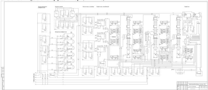
Сырая нефть со склада поступает на насос Н1. При проектном расходе сырой нефти в работе будет находиться один насос. Регулирование расхода сырой нефти осуществляется с помощью расходомера и частотного преобразователя насоса.
